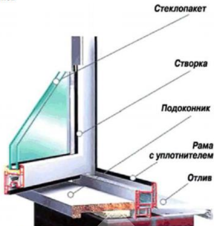
Рисунок 1. Конструкция пластикового окна
