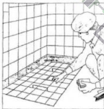
Рисунок 20. Укладка плитки в ячейки шаблона
