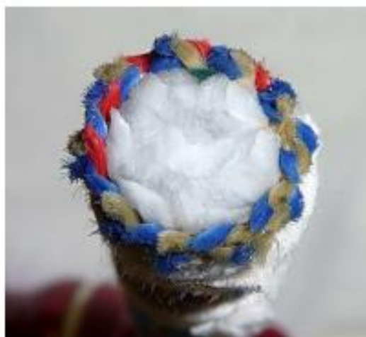
Канаты анкерной линии и страховочной системы
