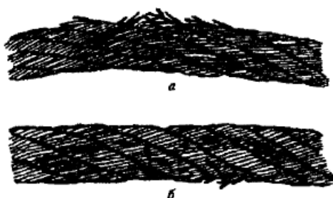
Рисунок 3. Обрывы проволок в зоне уравнительного блока:
