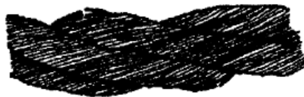
Рисунок 1. Обрывы и смещения проволок каната крестовой свивки.
