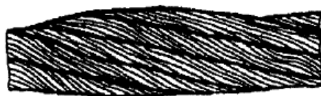
Рисунок 13. Местное увеличение диаметра каната.
