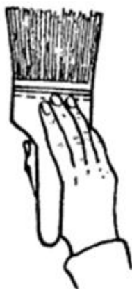
Схема флейцевания поверхности
