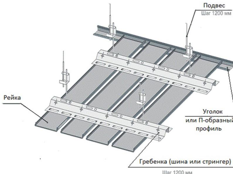
Конструкция реечного потолка
