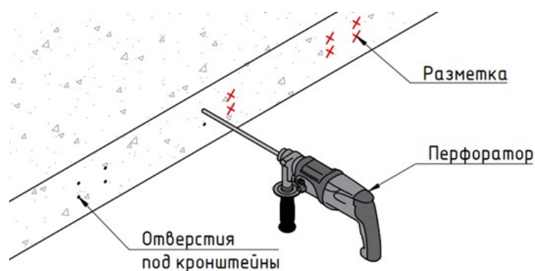
Схема устройства отверстий (Схема показана условно)
