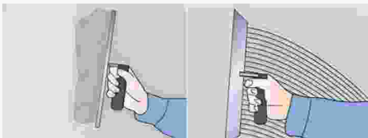
Рисунок 64 - Нанесение и разравнивание раствора
