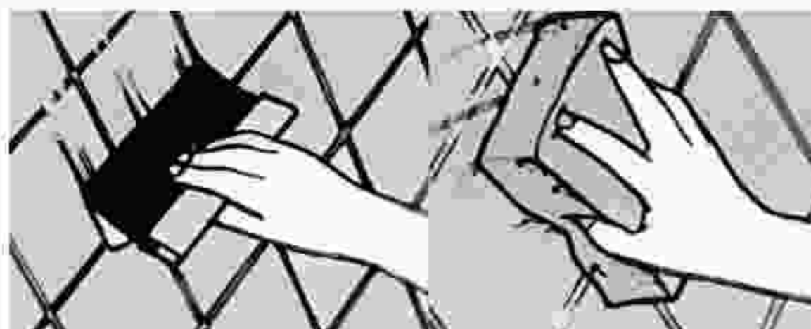
Рисунок 66 - Распределение и удаление лишнего раствора
