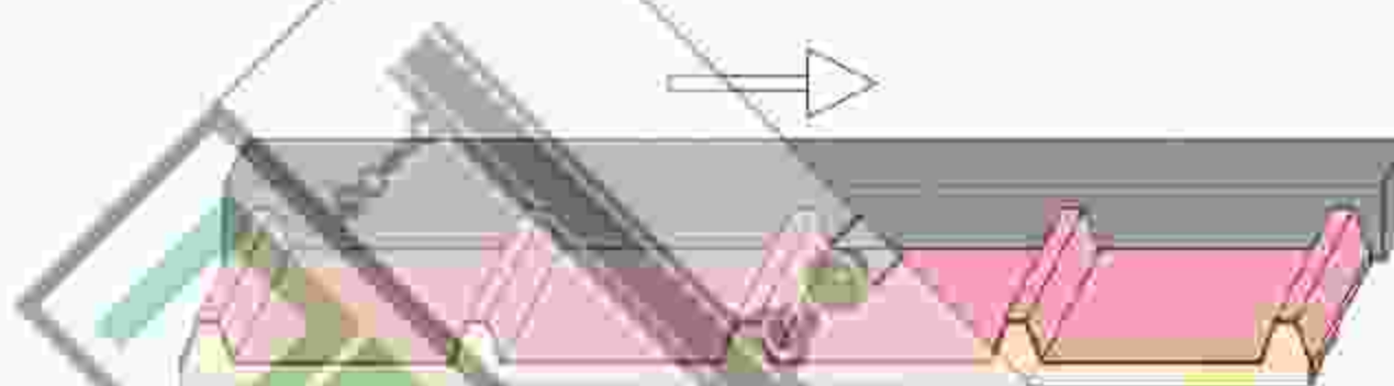
Рисунок 43 – Оформление свеса крыши (Стрелкой показано направление укладки фасонных элементов)
