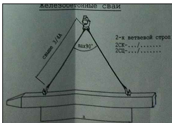
Рис.5 Схема строповки свай
